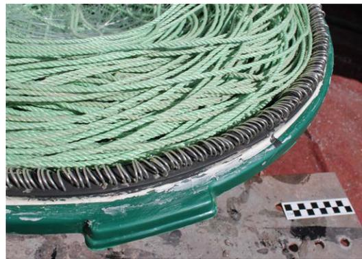
**Figura 4.** Detalle borde superior palangre con sus anzuelos.
