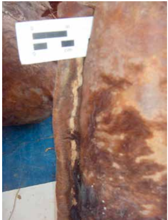
Figura 10. Cosido lateral mediante empleo de aguja e hilo de cáñamo grueso.
