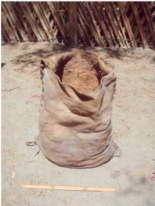
Figura 7. Zurrón o capacho pequeño en cuero grueso de animal (¿lobo marino?). Usado por los apires para el transporte del mineral.
